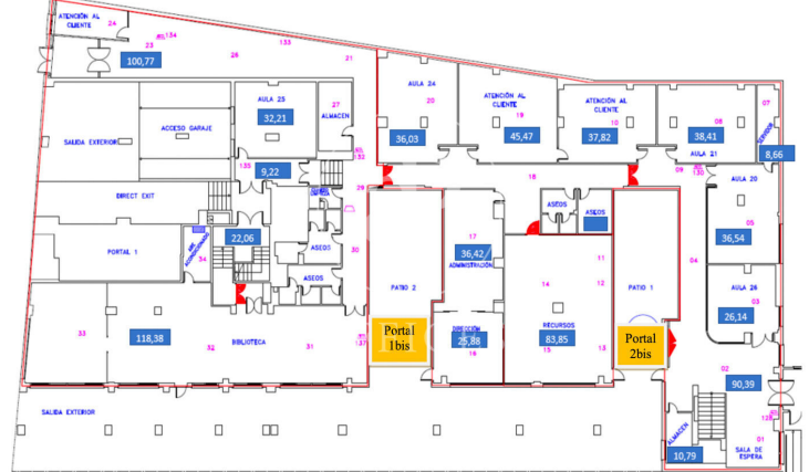
el cuadro azul se muestra la superficie en m2 de cada aula/estancia.
